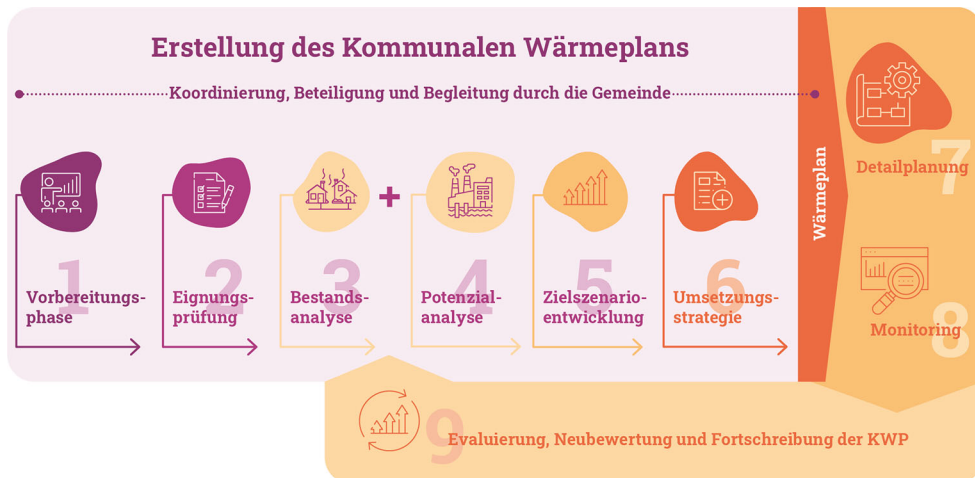
Abb. 2 KWW-Prozessgrafik zur Kommunalen Wärmeplanung. (© dena/KWW [KWW 2025b])
